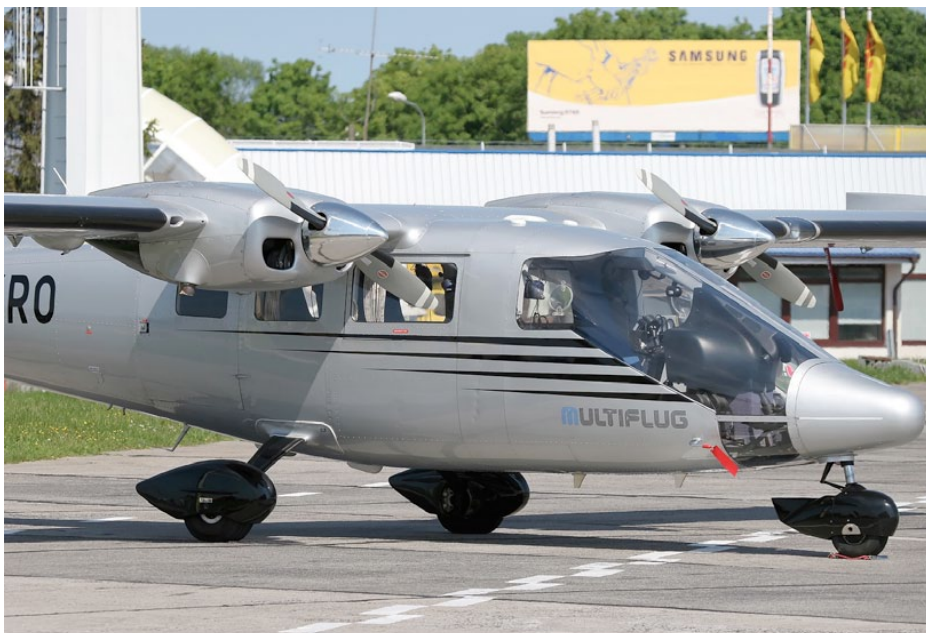
Die P68 Observer ist eine für Überwachungsaufgaben modifizierte Version. Das weitgehend verglaste Cockpit erlaubt Sichtverhältnisse wie aus einem Hubschrauber. Für private Anwendungen ist diese Variante jedoch uninteressant. Bild: Kamil Macniak
