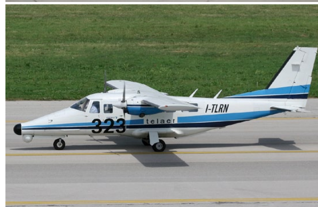
Die Weiterentwicklungen der P68. Oben: P68 „Spartacus“ mit zwei 330 PS Allison-Turbinen und festem Fahrwerk. Unten: AP68TP-600 „Viator“ ebenfalls mit Allison-Turbinen, aber mit verlängertem Rumpf und Einziehfahrwerk. Bild unten: Vulcanair
